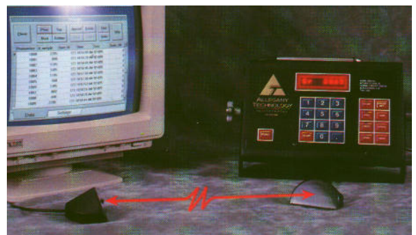
Alle Daten werden an einem Ort zentral verwaltet. Mittels des neuen Infra-Line-Datenübertragungssystems sind alle wesentlichen Daten in Sekundenschnelle im PC und können dort verwaltet werden. So ist es besonders einfach, immer den Überblick zu behalten.
