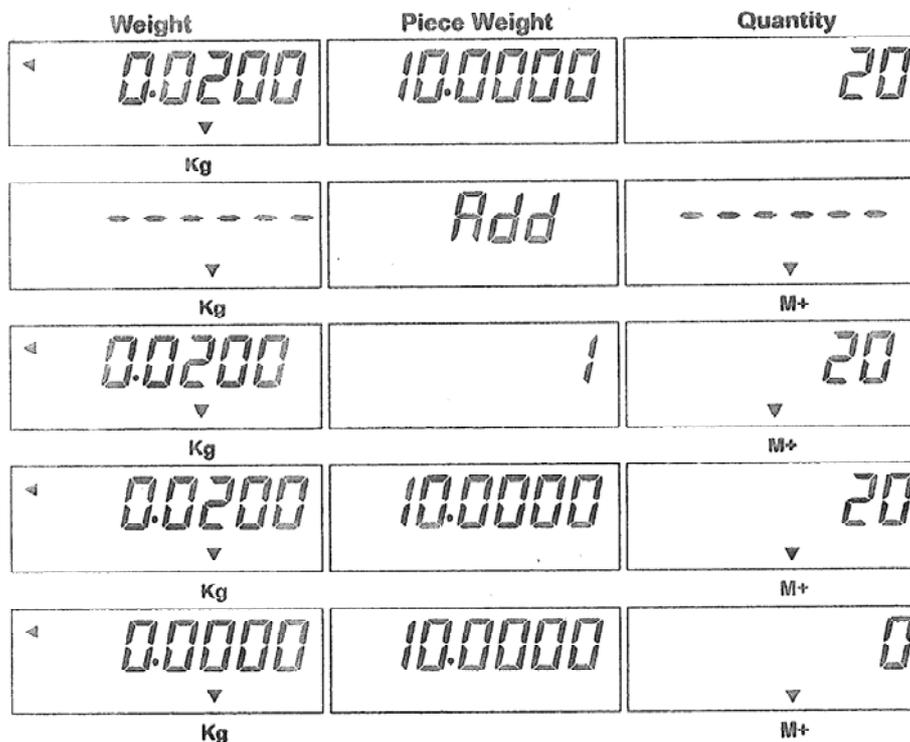
Zum Abrufen des Summenspeichers drücken Sie die Taste **M+/MR** ohne dass sich ein Gewicht auf der Wägeplatte befindet. Die Daten werden angezeigt. Drücken sie daraufhin die Taste **M+/MR**, um zum normalen Wägebetrieb zurückzukehren und die Summenanzeige "▼" ist eingeschaltet.
