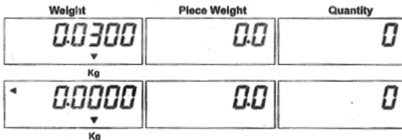
**05.04.02 Bei belasteter Wägeplatte (z.B. 277g):**
