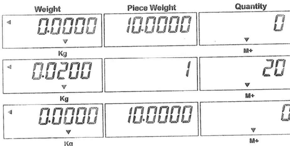
Zum Löschen des Summenspeichers drücken Sie die Taste **M+/MR** ohne dass sich ein Gewicht auf der Wägeplatte befindet. Die Angaben werden angezeigt, drücken Sie dann die Taste **C** zum Löschen der Summierungsdaten. Die Waage kehrt dann in den normalen Wägebetrieb zurück nachdem Sie die gesamten Summendaten gelöscht haben und die Summenanzeige "▼" geht aus
